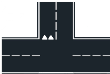
Figuur 26: Schematische weergave geplande vormgeving kruispunt wijkontsluitingsweg midden
