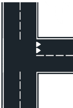
Figuur 31: Schematische weergave geplande vormgeving kruispunt wijkontsluitingsweg zuid-oost
