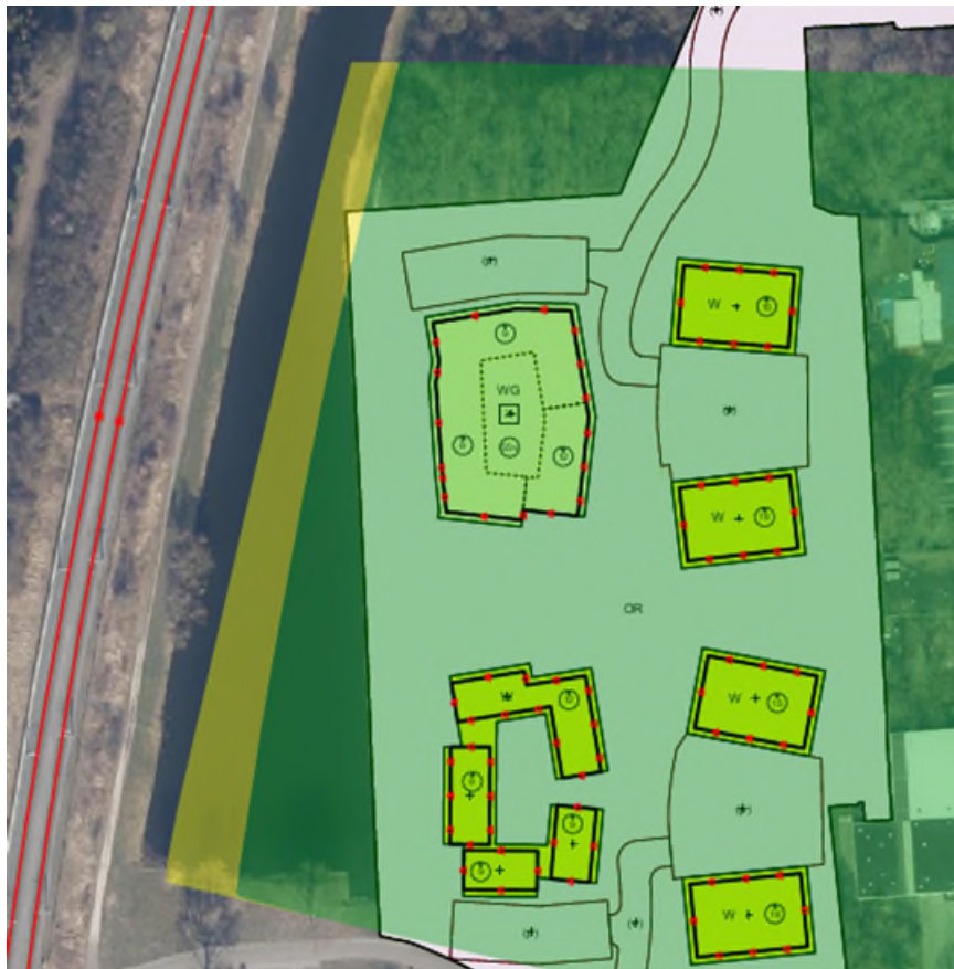
Afbeelding 3: Indicatief berekende contouren trillingsniveau V_{eff,max} op vloerniveau van het beoogde plangebied.
